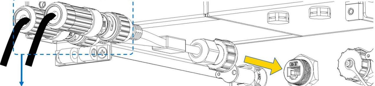
Bitte verwenden Sie hier IP65 Wasserdichte RJ45 Steckverbindungen
